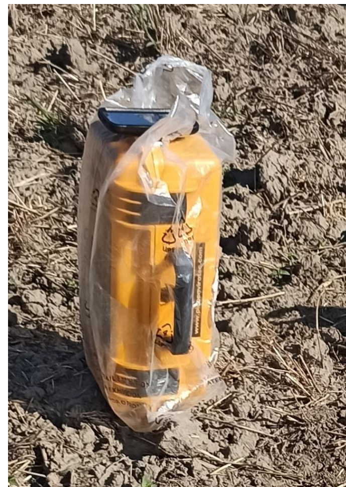
Obr. 5 Použitý prístroj terénny gamaspektrometer PGIS-2 (foto: vlastné)
