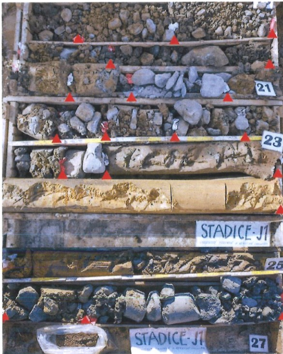
Obr. 3 Vrt procházející spodní částí sesuvu, jádro z hloubky 18–27 m. Při bázi vrtu byly zastíženy štěrky a písky z terasy řeky Bíliny, které byly sesuvem pohřbeny
