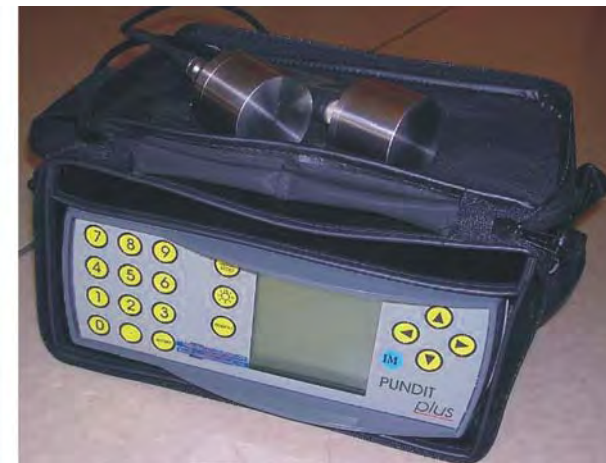
Obr. 3: Vlevo ultrazvukový přístroj TICO se zvukovými sondami 54kHz ( Proseq, Švýcarsko); vpravo ultrazvukový přístroj PUNDIT plus se zvukovými sondami 54kHz ( Mastrad, Velká Británie )
