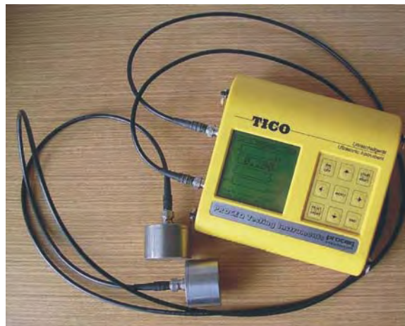
Obr. 3: Vlevo ultrazvukový přístroj TICO se zvukovými sondami 54kHz ( Proseq, Švýcarsko); vpravo ultrazvukový přístroj PUNDIT plus se zvukovými sondami 54kHz ( Mastrad, Velká Británie )
