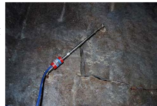
Obr. 3 Fotografie měřicích míst: měření změny úrovně hladiny důlní vody – KV5 (nahore) a měření rozvírání trhliny – KS1 (dole), foto: Lednická
