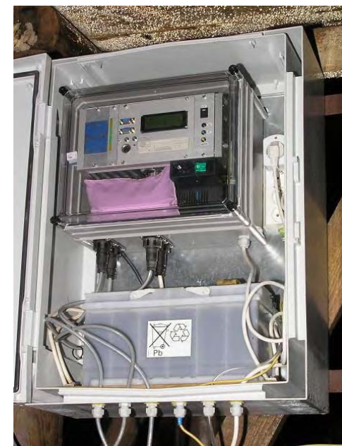
Obr. 1 Obecné blokové schéma distribuovaného měřicího systému (vlevo; Knejzlík, 2006), instalace měřicí ústředny ve vodotěsné skříni s jednotkou MU611 (slave – ADR1) a DC/DC konvertorem (vpravo nahoře), instalace seizmické registrační aparatury PCM3-MU (master – ADR0) v Dole Jeroným (vpravo dole)
