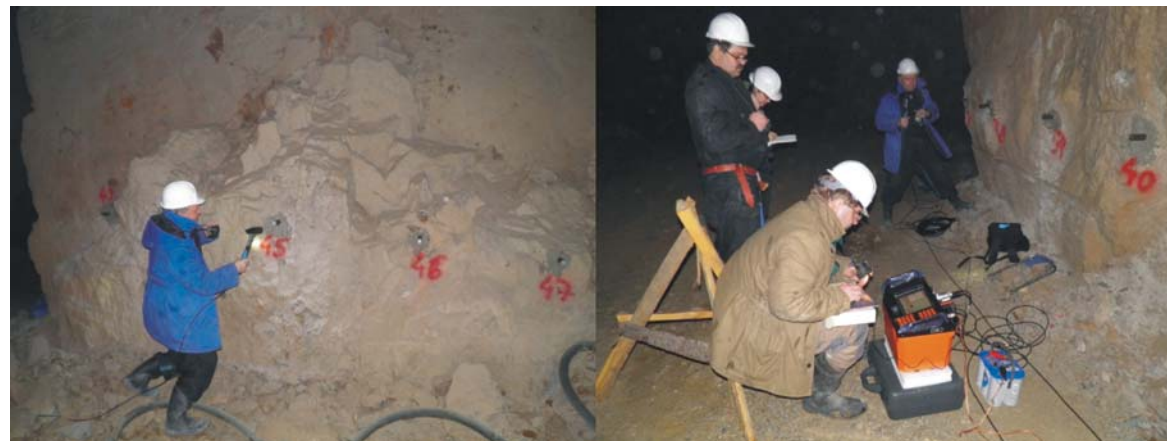
Obr. 3 Spôsob budenia signálu kladivom a registrácia signálu meracou aparátúrou Terralock Mark 8.
