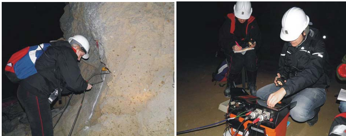
Obr. 3 Meranie pomocou prístroja Terraloc Mark 8
