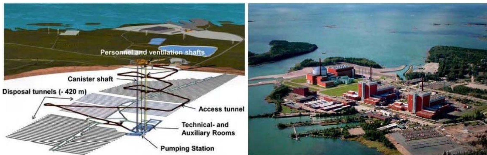
Obr. 3 Projekt Olkiluoto , vlevo koncept úložiště a vpravo jaderné elektrárny (dle www.posiva.fi )
