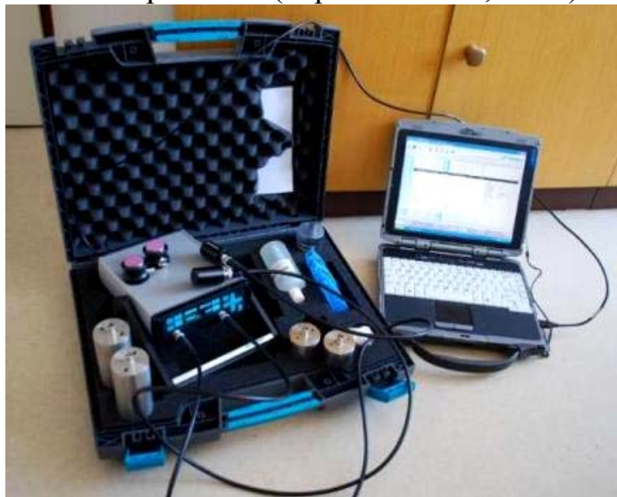
Obr.1 Ultrazvuková aparatura Pundit Lab + firmy Proceq se sadou měřících sond (foto: Lednická), vpravo výstup naměřeného vlnového záznamu v programu Punditlink – nahoře měření podélné vlny, dole měření příčné vlny
