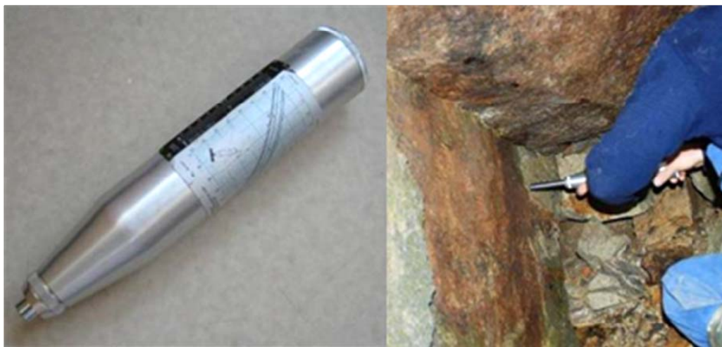
Obr.3 Vlevo: Schmidtovo kladívko typu N, vpravo: měření odrazu Schmidtovým kladívkem v Dole Jeroným (foto: Lednická)
