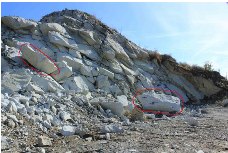
Obr.3 Lavicovitá až bloková odlučnosť a uvoľnené a zrútené skalné bloky rozmerov cca 1x1x2 m
