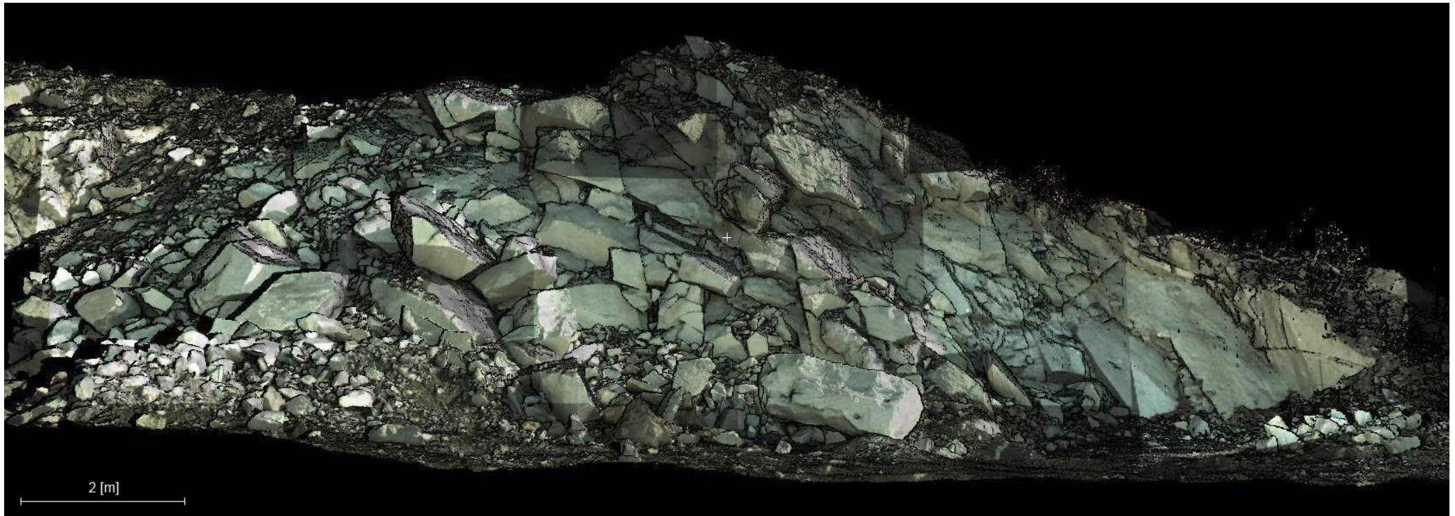
Obr.5 Spracovanie nameraných dát v programe Trimble RealWorks - panoramatický pohľad na meranú lomovú stenu
