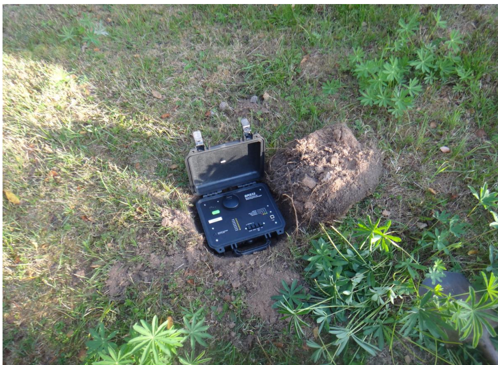
Obr.3 Příklad uložení záznamníku BRS 32 při terénním měření
