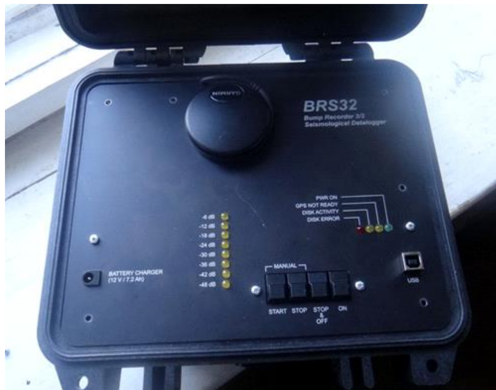
Obr. 1 Provedení přístroje s integrovaným snímačem LE3D (Lennartz Electronic), GPS a akumulátorem (12V/7Ah)
