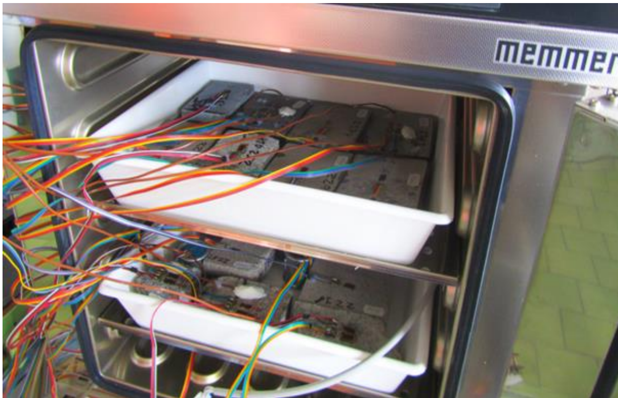
Obr. 10 Vzorky hornin v klimatizační komoře při měření vlivu navlhnutí
