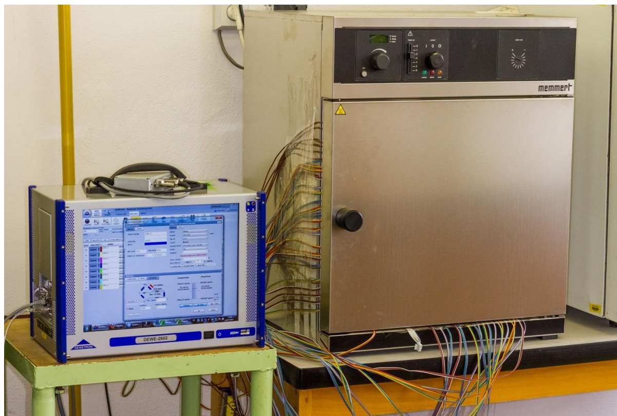
Obr. 3 Měřicí ústředna Dewetron DEWE-2602 s klimatizační komorou
