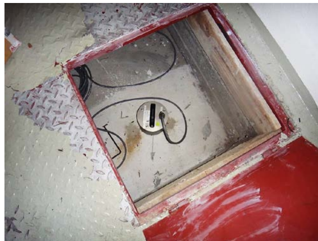
Obr. 5. Umístění snímače Guralp na pilíři (stanice Háje)
