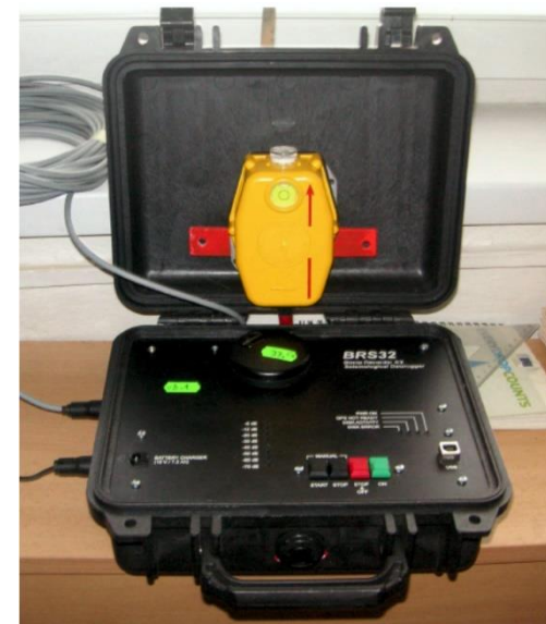
Obr. 1 Polní seismická aparatura typu BRS32 s interním nebo externím tříšložkovým seismickým snímačem rychlosti kmitání typu SM6-3D
