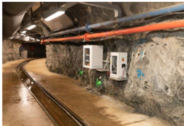
Obr. 3 Celkový pohled na soustavu SGI 1 umístěnou v PVP Bukov (a), výřez se skříněmi pro přístrojovou techniku, vlevo geoelektrická a vpravo seismická část (b)
