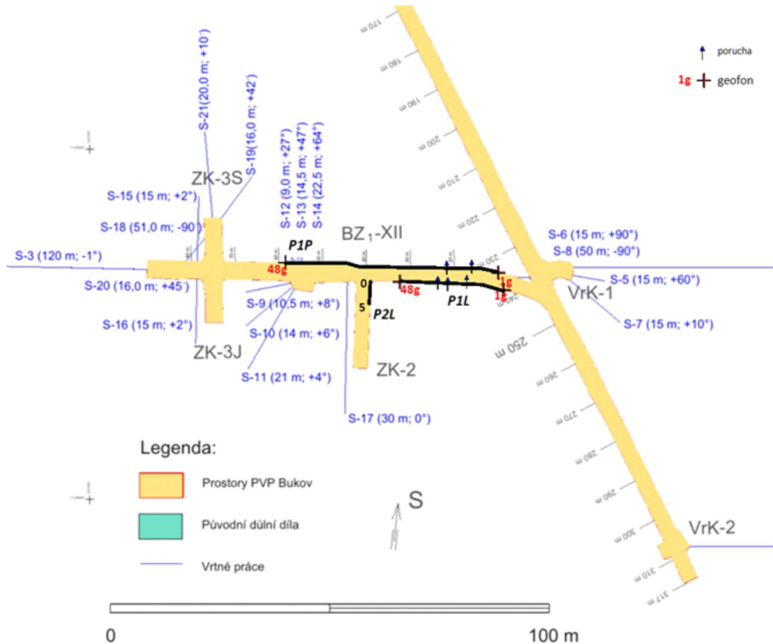
Obr. 2 Mapové schéma PVP Bukov. Geofyzikální profily P1L, P1P a P2L jsou vyjádřeny silnými černými liniemi
