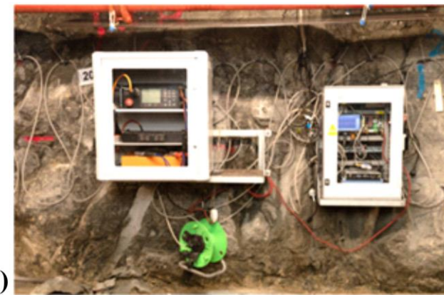
Obr. 3 Celkový pohled na soustavu SGI 1 umístěnou v PVP Bukov (a), výřez se skříněmi pro přístrojovou techniku, vlevo geoelektrická a vpravo seismická část (b)
