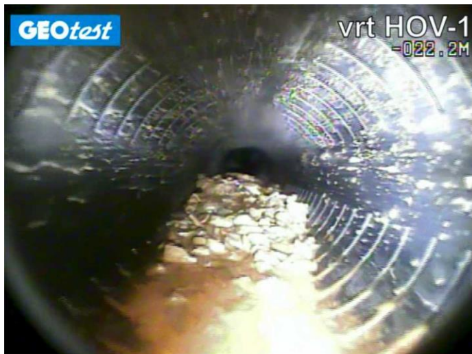
Obr. 8 Úlomky hornin sesuvu ve vrtu HOV1
