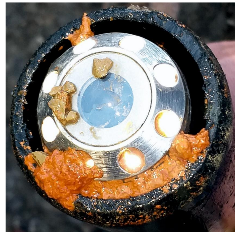
Obr. 11 TV kamera po vytažení z vrtu
