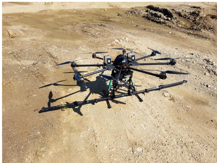
Obr. 3 Podvěsný 3D magnetometr, měřený záběr 2,5 m
