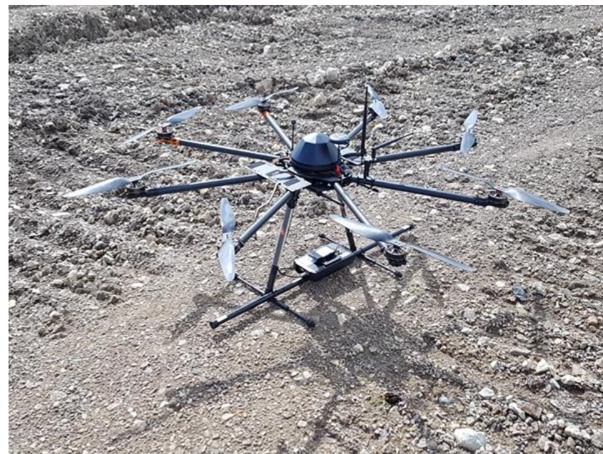
Obr. 2 Podvěsný 3D magnetometr, měřený záběr 1,0 m
