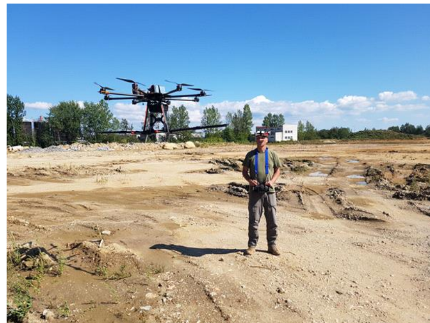
Obr. 4 Podvěsný 3D magnetometr, měřený záběr 2,5 m
